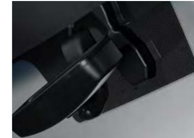
Modul cameră video față cu senzor de ploaie și control automat al farurilor
