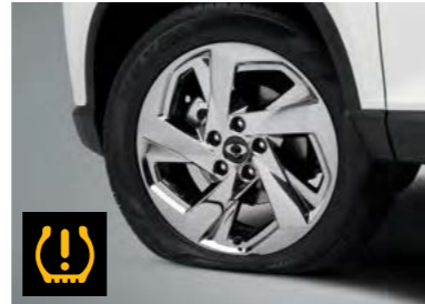
Sistem de monitorizare a presiunii în pneuri/Tyre pressure monitoring system (TPMS)
