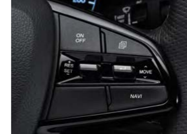
Comutatoare pentru controlul vitezei de croazieră montate pe volan
