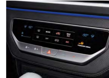
Aer condiționat manual
