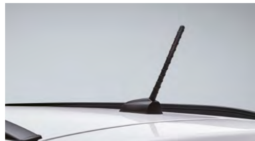
Antenă tip tijă montată pe acoperiș
