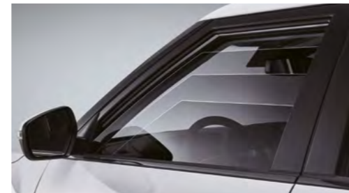
Geam șofer cu acționare electrică și sistem de siguranță
