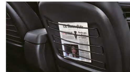
Suport pentru hârtii pe spăarele scaunelor, din cordon elastic în formă de buclă
